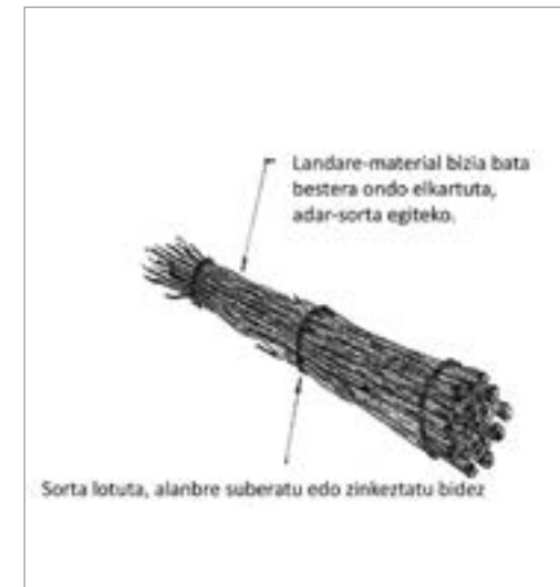
100. irudia. Adar-sorta: eraikuntza-xehetasuna. Iturria: Manuale Ingegneria Naturalistica - AIPIN
