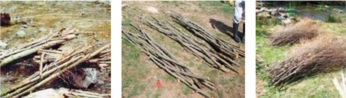
34. irudia. Aldaxkak, hagak eta adarrak. Iturria: P. Sangalli. Ibai bioingeniaritza – Kantauri eremurako eskuliburu teknikoa
