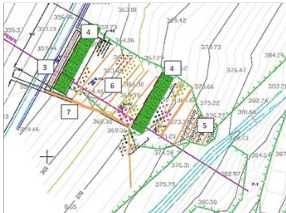
Imagen 45. Localización del desprendimiento 2011. Perfil de intervención y planta con soluciones propuestas. Fuente: P. Sangalli - SCIA S.L. - IKERLUR S.L.
