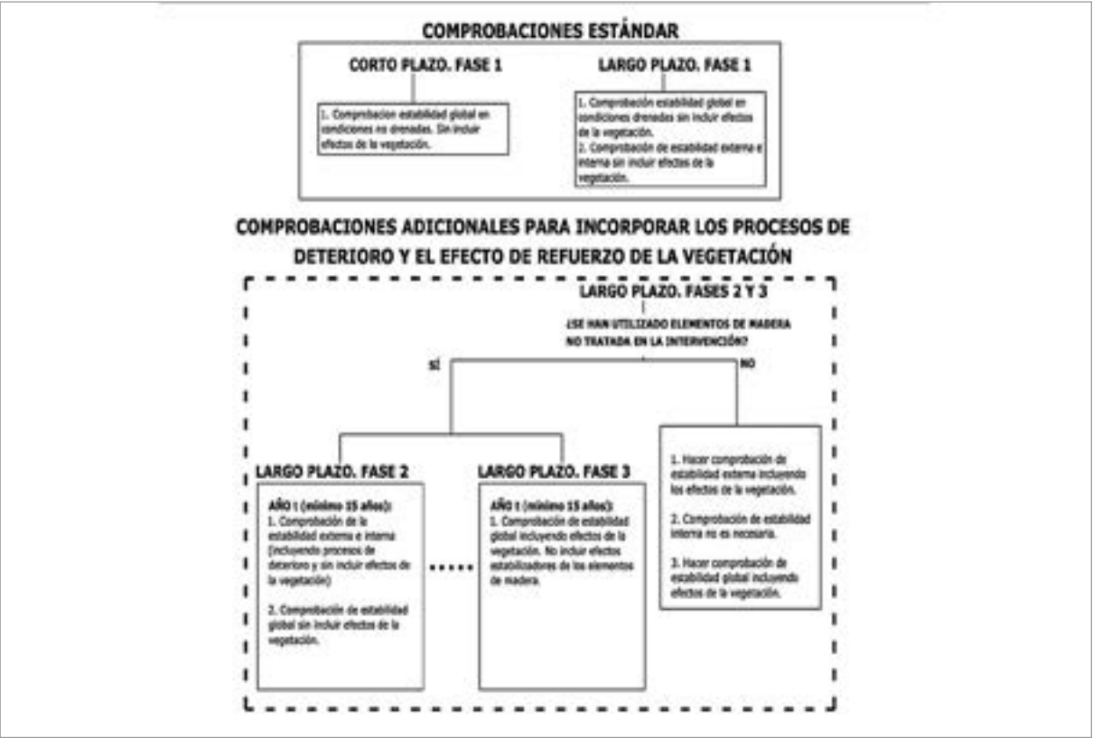
Imagen 31. Metodología Tardío & Mickovski. Metodología de diseño de las obras de bioingeniería incluyendo procesos de deterioro de los materiales y efectos de refuerzo de la vegetación. En el ejemplo de la imagen se ha definido un hito temporal en t = 15 años (como valor mínimo). Se ha de asegurar, en las FASES 2 y 3, la estabilidad del sistema durante un periodo mínimo de 15 años
