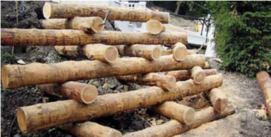
Imagen 35. Troncos de madera descortezados para estructuras como entramados y empalizadas
