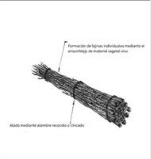
Imagen100. Fajina: detalle constructivo. Fuente: Manuale Ingegneria Naturalistica - AIPIN
