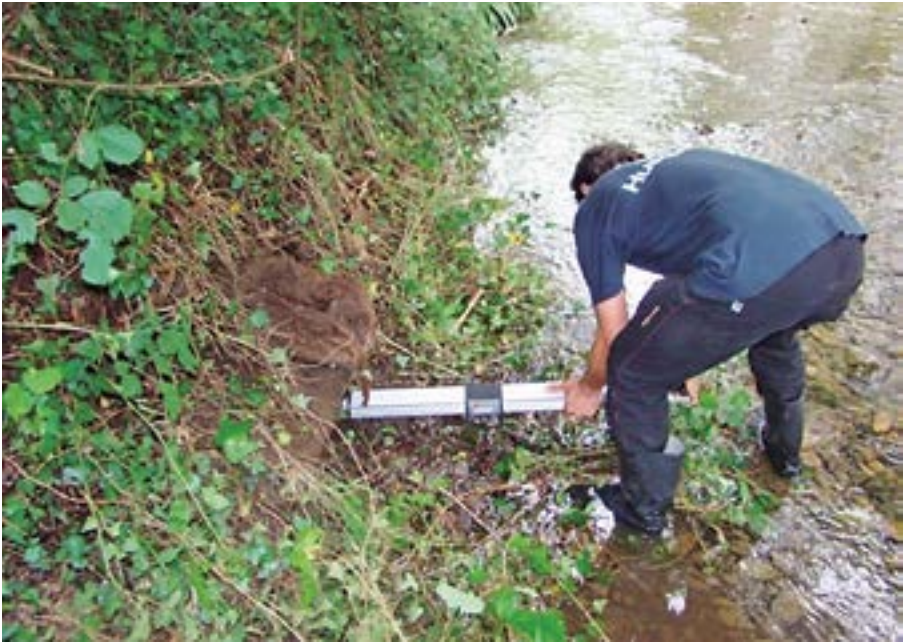
Imagen 32. Análisis, mediante resistógrafo, del estado de deterioro de los troncos utilizados en un entramado de madera en el río Artia (Irún, Guipúzcoa). Fuente: G. Tardío.
