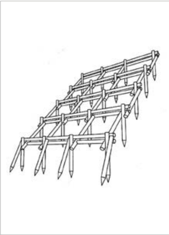
Imagen 171. Variante enrejado vivo “Vesubio”. Fuente: G. Menegazzi con dibujo de S. Sangalli - SCIA S.L.
