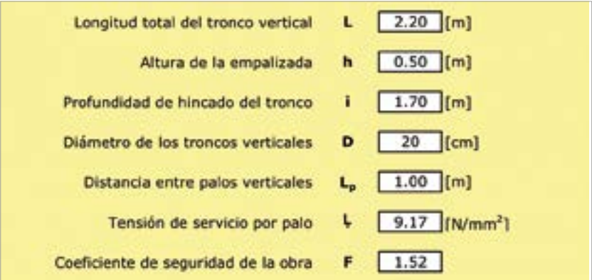
Imagen 125. Resumen de resultados de la aplicación (incluye el cálculo de la profundidad de hincado necesaria)
